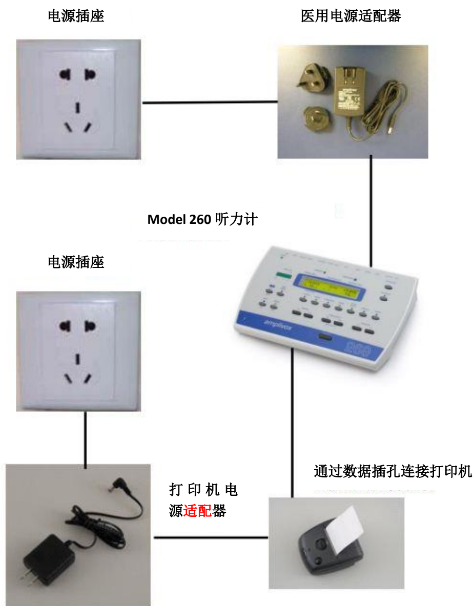
图2: 260型听力计与医疗认证电源适配器及打印机使用
