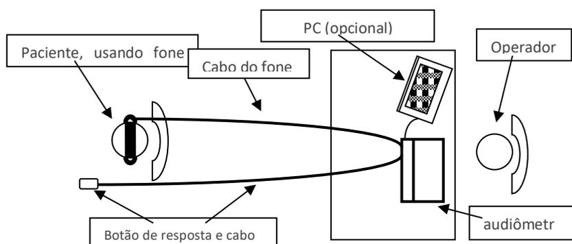
O esquema acima mostra um exemplo típico da utilização do equipamento. O audiômetro localiza-se na mesa do operador:
