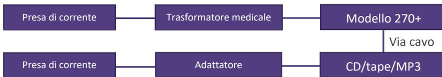
Diagramma 5: Modello 270+ utilizzato con l'adattatore di rete approvato dal medico e l'altoparlante esterno
