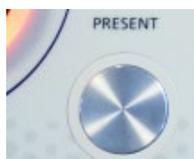
Il pulsante di presentazione si trova a destra della manopola di controllo del canale 1 (attenuatore). Il pulsante è conduttivo, toccandolo il segnale di test sarà presentato al paziente (in modalità di presentazione) oppure interrotto (in modalità continua).
