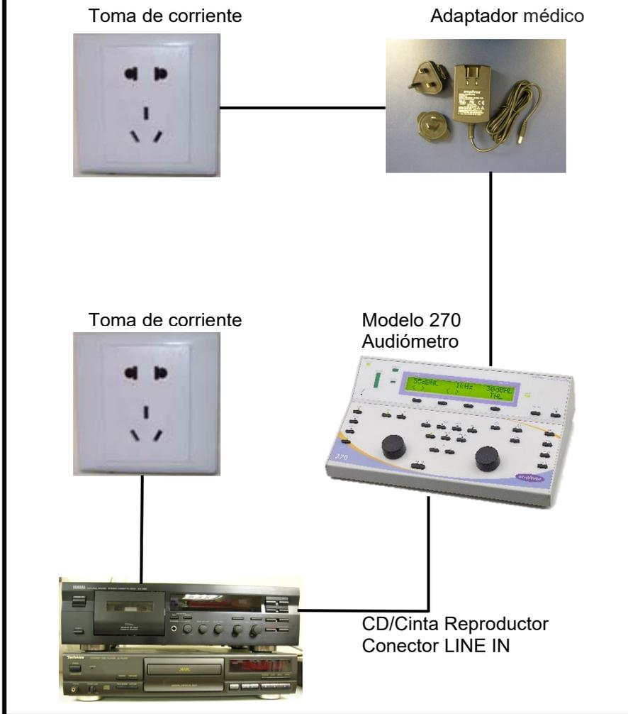
Diagrama 5: Modelo 270 (usado con suministro de corriente aprobado medicamento) y amplificador externo
