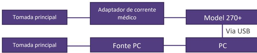
Diagrama 4: 270+ usado com o adaptador de corrente clinicamente aprovado e CD/TAPE
