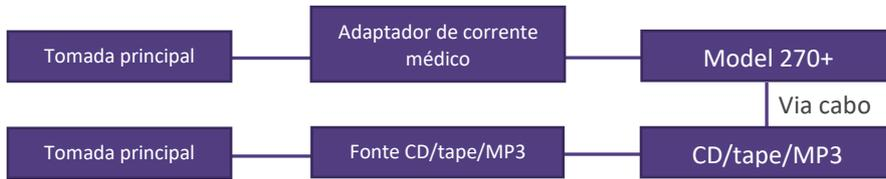
Diagrama 5: 270+ usado com o adaptador de corrente clinicamente aprovado e amplificador externo
