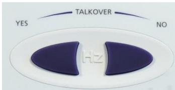
Para ajustar os níveis de audição do monitor, os botões de controle de frequência podem ser usados.
