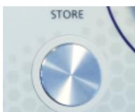
O botão de armazenamento está localizado à esquerda do controle rotativo do canal 2. O botão é condutor, tocando nele, o nível e a frequência atuais do teste serão armazenados na memória temporária do dispositivo.
