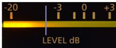
x El medidor de VU no alcanza la línea de 0dB
