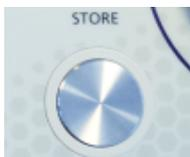
El botón de almacenamiento se encuentra a la izquierda del control giratorio del canal 2 (Channel 2). El botón es conductor, al tocarlo, el nivel de prueba actual y la frecuencia se almacenarán en la memoria temporal del dispositivo.
