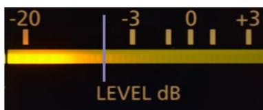
x El medidor de VU no alcanza la línea de 0dB.
