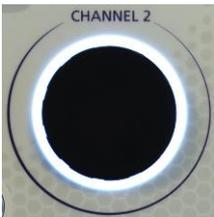
Tan pronto como se enciende el canal de enmascaramiento, el anillo de luz alrededor del control giratorio del canal 2 (Channel 2) se ilumina en blanco.
