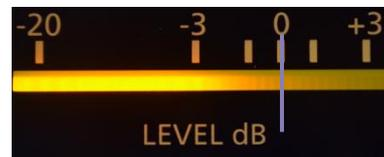
a El medidor de VU alcanza la línea de 0dB
