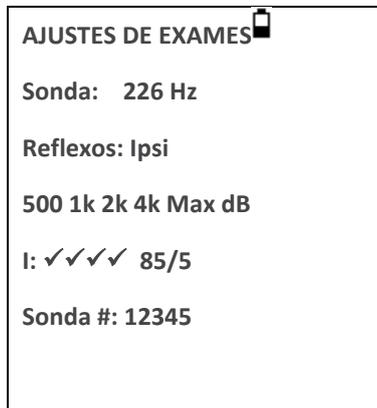
Ela indica a frequência que está sendo usada na sonda, a fonte de reflexo selecionado, as frequências selecionadas, nível máximo e os passos em dBs de estímulo do reflexo. Também são mostrados os números de série de sonda.
