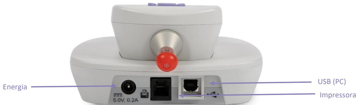
A saída do adaptador de rede é equipada com proteção de circuito eletrônico. Em caso de sobrecarga, o adaptador será desligado. Quando a falha for eliminada, o adaptador funcionará normalmente. No entanto, a entrada do adaptador de rede é protegida por um fusível não substituível. Se isso falhar, o adaptador não funcionará. Se for necessário um adaptador de rede de substituição, entre em contato diretamente com a Amplivox ou com o seu distribuidor.
