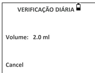
Retire a sonda e repita o teste com as três cavidades de teste restantes. A tela deve mostrar o volume da 0,2 ml, e cavidade de teste de 0,5 ml dentro de  $\pm 0,1$  ml. O volume da cavidade teste 5,0 ml deve ser mostrada dentro de  $\pm 0,25$  ml.
