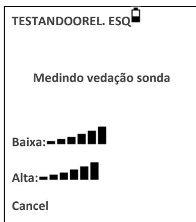
O número de barras mostrado, indica a qualidade davedação. A sonda deve ser ajustada na orelha até que duas ou mais barras sejam mostradas paraBaixaeAlta. O método utilizado para a verificação de vedação completa da orelha estabelece um limite máximo no volume do canal auditivo de ~4.5ml.
