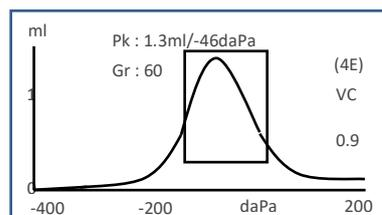
O modo de tela padrão é + 200daPa de deslocamento (como mostrado no diagrama da esquerda e indicado por 2E natela), mas um deslocamento de - 400daPa pode ser Selecionado se necessário (como mostrado no diagrama a direita e indicado por 4E natela). Consulte a seção 5.5.3 para detalhes de como alternar entre os modos de exibição disponíveis.
