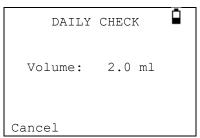
Rimuovere la sonda e ripetere il test con le tre cavità rimanenti. Il display dovrebbe mostrare il volume delle cavità di test da 0,2ml e 0,5ml entro ± 0,1ml. La cavità di test da 5,0 ml deve essere entro ± 0,25 ml. Al termine dei controlli, premere ◀ per tornare al menu principale.
