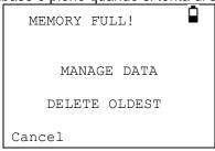
Selezionando GESTIONE DATI verrà visualizzato il menu GESTIONE DATI che fornisce le opzioni per la stampa o il trasferimento dei dati su un computer prima della cancellazione dei record per fare spazio al nuovo test.
