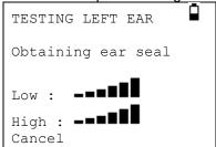
Il numero di barre indicate indica la robustezza della tenuta. La sonda deve essere regolata nell'orecchio fino a quando due o più barre sono indicate per Low & High.
