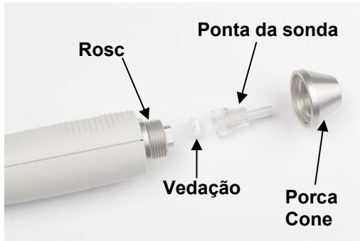
Os pequenos buracos na ponta da sonda do Otowave devem ser mantidos limpos. Se eles ficarem bloqueados uma mensagem de aviso será mostrada. A ponta da sonda deve ser retirada e limpa ou deve ser substituída.
