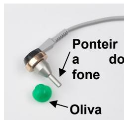
Este acessório é usado quando é necessário obter um estímulo de reflexo da orelha oposta àquela que está sendo testada com a sonda principal. Para ser usado deve estar conectado ao soquete CONTRA na unidade base e equipado com uma nova oliva (consulte a seção 5.3)
