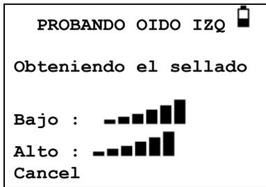
Cuantas más barras se muestren, más calidad tendrá el sellado del oído. La sonda debe ajustarse en el oído hasta que se muestren dos o más barras para Baja y Alto. El método utilizado para la opción minucioso pone un límite máximo de volumen del canal auditivo de 4,5 ml aproximado.
