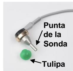
Este accesorio se utiliza cuando es necesario para obtener una estimulación refleja del oído opuesto al que se está probando con la sonda. Para ser utilizado debe estar conectada a la toma "CONTRA" en la unidad y equipado con una nueva tulipa (ver Sección 5.3).
