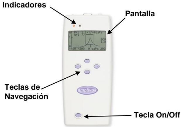
Presione las teclas de navegación arriba ▲ y abajo ▼ para desplazarse en el menú o fijar valores.
