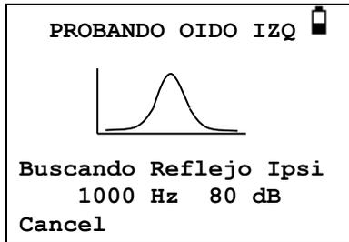
La pantalla cambia para mostrar la frecuencia y el nivel usado, empezando con la frecuencia más bajar y el nivel seleccionado.
