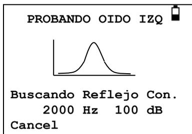
Cuando la medición está completada, el indicador del instrumento cambia del verde parpadeante al verde fijo. La pantalla confirma que el test se ha completado junto con la instrucción RETIRAR SONDA.
