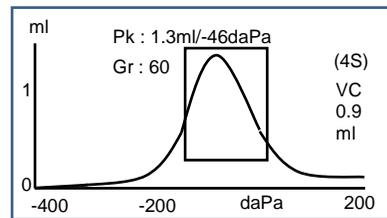
El modo de referencia por defecto es un desplazamiento de +200daPa (como se muestra en el diagrama de la izquierda y se indica por 2S en la pantalla). Si se requiere, se puede seleccionar un desplazamiento de -400daPa (como se visualiza en el diagrama de la derecha y se indica por 4S en la pantalla). Ver Sección 5.5.3 para más detalles sobre cómo cambiar entre los modos de referencia disponibles.
