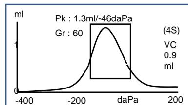
El modo de referencia por defecto es un desplazamiento de +200daPa (como se muestra en el diagrama de la izquierda y se indica por 2S en la pantalla). Si se requiere, se puede seleccionar un desplazamiento de -400daPa (como se visualiza en el diagrama de la derecha y se indica por 4S en la pantalla). Ver Sección 5.5.3 para más detalles sobre cómo cambiar entre los modos de referencia disponibles.
