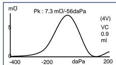
El formato es generalmente similar al utilizado para el modo Scalar con el tono de sonda a 1000Hz. Una vez más, el desplazamiento de +200daPa (2V) y el desplazamiento de -400daPa (4V) están disponibles para cuando sea necesario.
