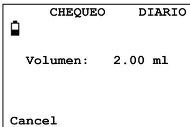
Quitar la sonda y repetir la prueba con las tres cavidades de ensayo restantes. La pantalla debe mostrar el volumen de las cavidades de 0,2 ml y 0,5 ml de prueba de  $\pm 0,1$  ml. La cavidad de ensayo 5,0 ml debe estar dentro de  $\pm 0,25$  ml.
