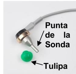
Este accesorio se utiliza cuando es necesario para obtener una estimulación refleja del oído opuesto al que se está probando con la sonda. Para ser utilizado debe estar conectada a la toma "CONTRA" en la unidad y equipado con una nueva tulipa (ver Sección 5.3).
