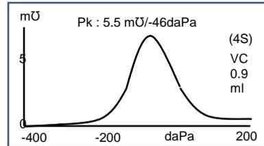
Para 1000Hz, el modo de referencia por defecto es Scalar con un desplazamiento de -400daPa (diagrama de la derecha y se indica por 4S en la pantalla). Se pueden seleccionar modos alternativos para 1000Hz si es necesario (ver Sección 5.5.3).
