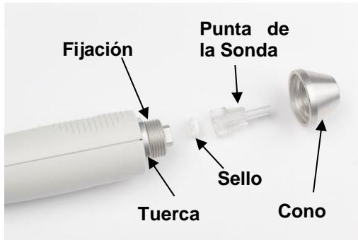
Los pequeños agujeros en la punta de la sonda deben mantenerse limpios. Si se bloquean aparecerá un mensaje de alerta en la pantalla. La punta de la sonda debe quitarse y limpiarse o reemplazarse.
