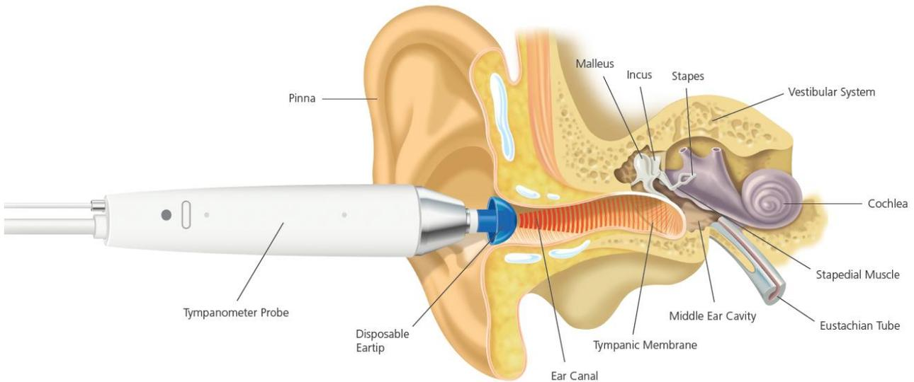
El sonido producido en el canal auditivo se mide usando un micrófono y la admitancia se calcula a partir de este resultado. De acuerdo con la práctica normal de audiometría, la admitancia aparece como un volumen equivalente de aire en ml (para 226Hz) o mmho/m<sup>2</sup> (para 1000Hz <sup>H</sup>).
