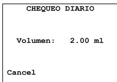
Quitar la sonda, espere hasta que se muestre "INSERTAR SONDA" y repetir la prueba con las tres cavidades de ensayo restantes. La pantalla debe mostrar el volumen de las cavidades de 0,2 ml y 0,5 ml de prueba de  $\pm 0,1$  ml. La cavidad de ensayo 5,0 ml debe estar dentro de  $\pm 0,25$  ml.
