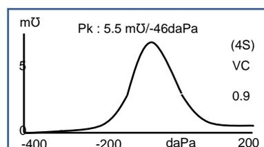
Para 1000Hz, el modo de referencia por defecto es Scalar con un desplazamiento de -400daPa (diagrama de la derecha y se indica por 4S en la pantalla). Se pueden seleccionar modos alternativos para 1000Hz si es necesario. Las unidades que se muestran en el eje vertical son mmho ( $m\ddot{U}$ ), que es una práctica normal para 1000Hz. El volumen del conducto auditivo (VC) se muestra en ml.
