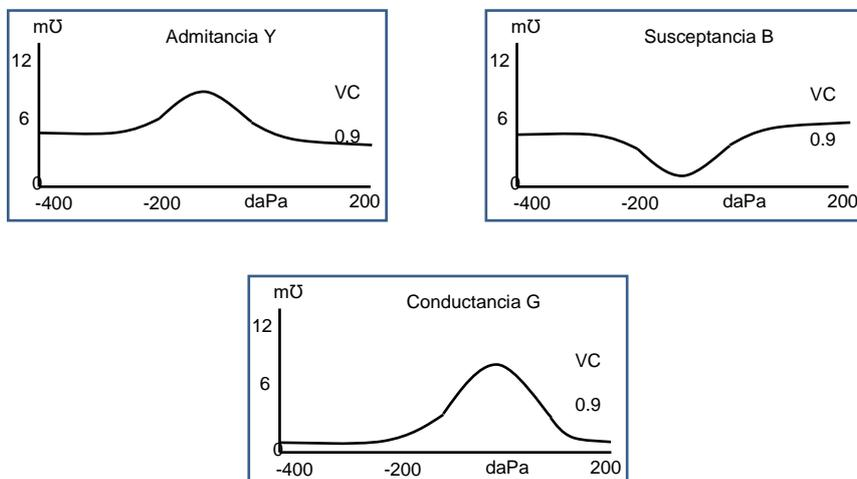
El modo Componentes se utiliza como es requerido por el audiólogo. En este caso el valor de VC se mide en condiciones de +200daPa desplazamiento en el modo Scalar.
