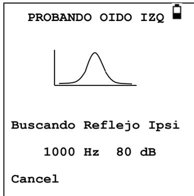
La pantalla cambia para mostrar la frecuencia y el nivel usado, empezando con la frecuencia más bajar y el nivel seleccionado.
