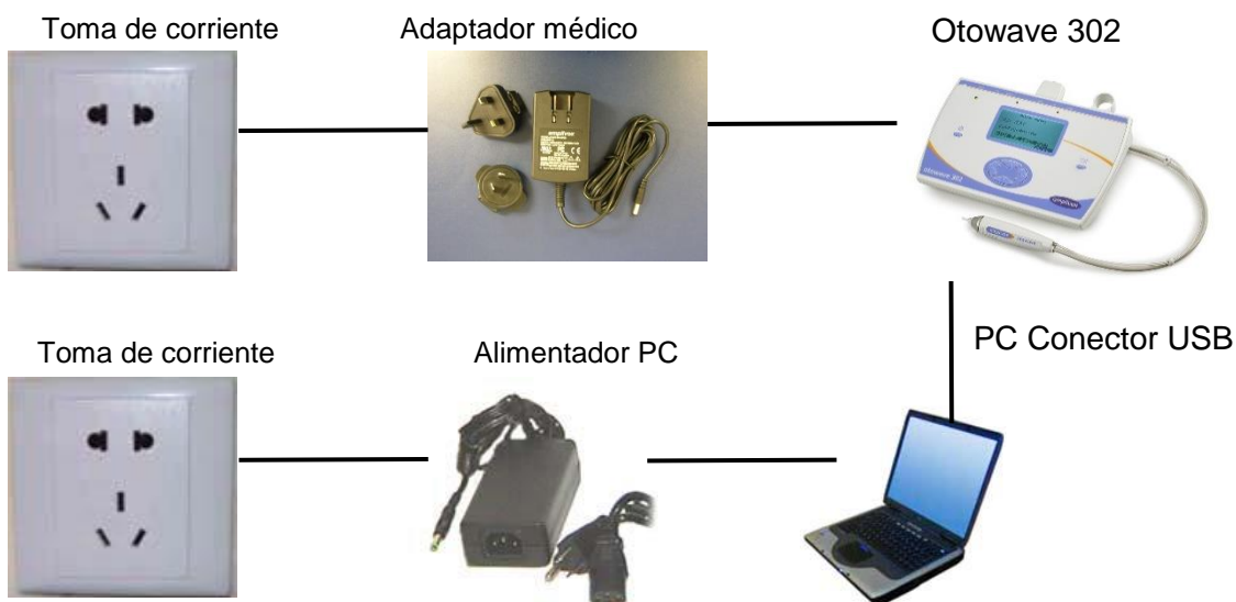
Diagrama 3: Otowave 302 usado con suministro de corriente aprobado medicamente y PC
