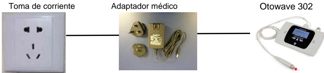
Diagrama 2: Otowave 302 usado con suministro de corriente aprobado medicamente e impresora suministrada
