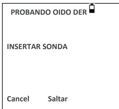
Presionar ► para salir de comprobar el oído derecho y ver el menú RESULTADOS PROCESO. Presionar ◀ para cancelar y volver al menú SELECCIONAR OÍDO. En ambos casos los resultados del oído izquierdo se guardan y pueden verse como último test.
