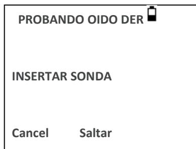
Presionar ► para salir de comprobar el oído derecho y ver el menú RESULTADOS PROCESO. Presionar ◀ para cancelar y volver al menú SELECCIONAR OÍDO. En ambos casos los resultados del oído izquierdo se guardan y pueden verse como ÚLTIMO TEST.
