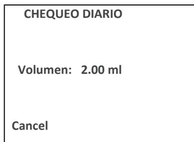
Quitar la sonda, espere hasta que se muestre "INSERTAR SONDA" y repetir la prueba con las tres cavidades de ensayo restantes. La pantalla debe mostrar el volumen de las cavidades de 0,2 ml y 0,5 ml de prueba de  $\pm 0,1$  ml. La cavidad de ensayo 5,0 ml debe estar dentro de  $\pm 0,25$  ml.
