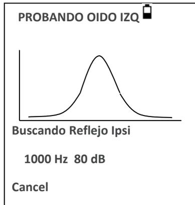
La pantalla cambia para mostrar la frecuencia y el nivel usado, empezando con la frecuencia más bajar y el nivel seleccionado.
