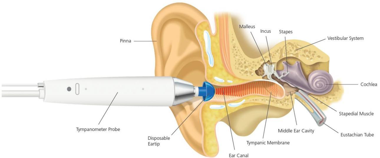
El sonido producido en el canal auditivo se mide usando un micrófono y la admitancia se calcula a partir de este resultado. De acuerdo con la práctica normal de audiometría, la admitancia aparece como un volumen equivalente de aire en ml (para 226Hz).
