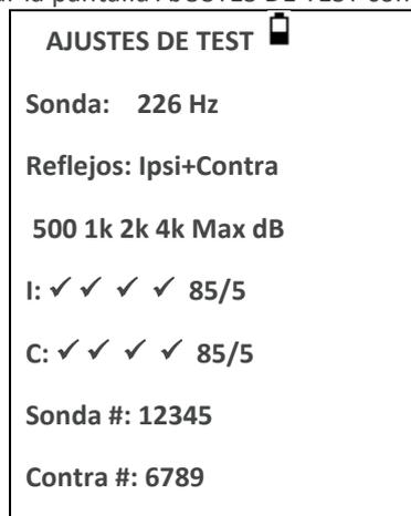
Esto indica la frecuencia de la sonda que se utilice, la fuente de reflejo seleccionado, las frecuencias seleccionadas, el nivel máximo y el tamaño de los pasos del estímulo reflejo. También muestran son los números de serie de la sonda y el transductor contralateral.
