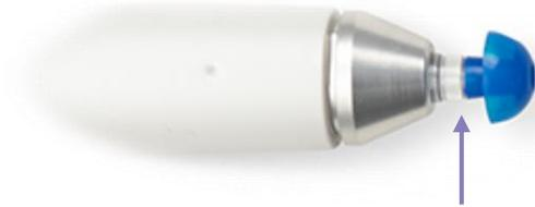
Asegúrese de que la tulipa esté presionada completamente hacia abajo en la punta de la sonda y que no haya espacio entre la punta de la sonda y la tulipa.
