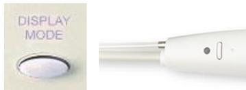
El cambio entre MODOS DE PANTALLA y DESPLAZAMIENTOS DE LÍNEA DE BASE se lleva a cabo utilizando la tecla de modo de pantalla en el panel frontal o el botón de función en la sonda.
