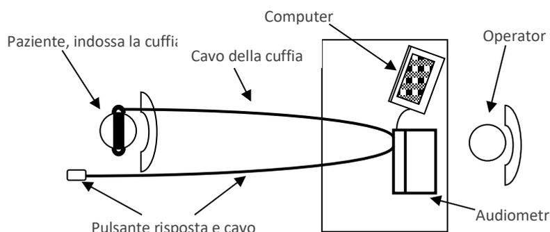
Il paziente è seduto di fronte alla scrivania rivolto verso l'operatore. Il paziente indossa una cuffia o un trasduttore appropriato (vedere Sezione 4.3) e risponde agli stimoli del test mediante un interruttore manuale collegato allo strumento.
