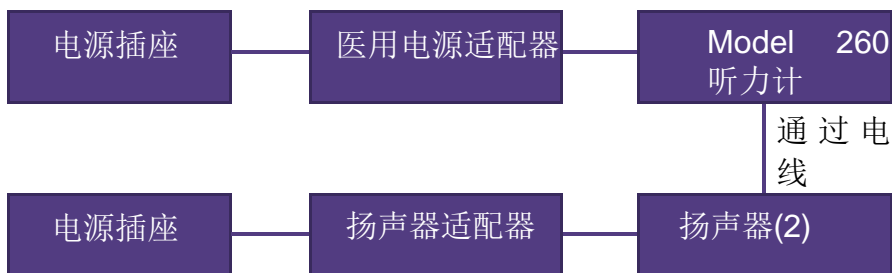
图5: Model 260 听力计与医学认可的电源适配器和外置扬声器一起使用
