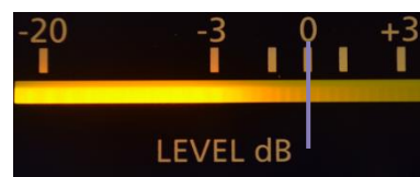
a El medidor de VU alcanza la línea de 0dB.
