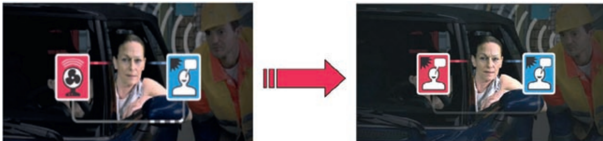
Figur 1: De to høreapparater opfanger forskellige omgivelser. I dette tilfælde vil den binaurale koordinatión fortælle systemet, at det skal prioritere tale i støjende omgivelser og indstille begge apparater til denne klassificering.
