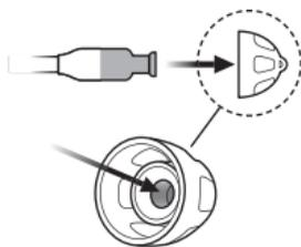
Setzen Sie den Hörer exakt in die Mitte des Ohrstücks, um einen sicheren Halt zu gewährleisten.
