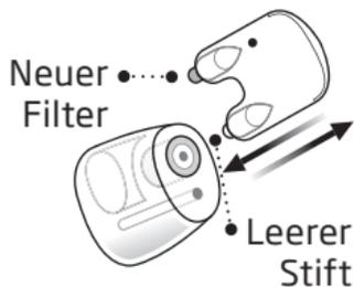
Drücken Sie den leeren Stift in den Cerumenschutz im Ohrstück und ziehen Sie den alten Cerumenschutz heraus.
