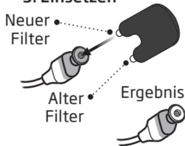
Setzen Sie den neuen Cerumenschutz mit dem anderen Stift ein, entfernen Sie das Werkzeug und entsorgen Sie es.
