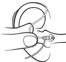
Halten Sie das gebogene Kabel des Hörers zwischen Daumen und Zeigefinger. Das Ohrstück sollte gerade zum Gehörgang zeigen.
