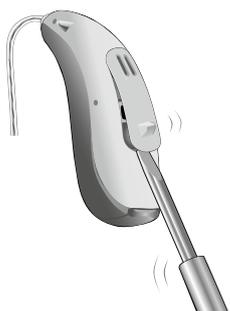
1 Удалите крышку аппарата с помощью отвертки, как показано.
