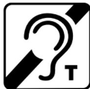
Индукционная катушка помогает Вам в прослушивании телефона со встроенной телефонной катушкой или в помещениях со встроенными индукционными системами в помещениях театров, церквей и лекционных залах. Такой или похожий символ указывает, что была установлена индукционная петля.
