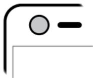
Автотелефон может автоматически активировать программу телефона в слуховом аппарате, если в телефоне установлен соответствующий магнит. Магнит должен быть расположен на Вашем телефоне недалеко от выхода звука.
