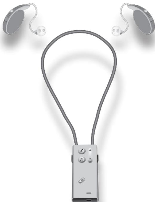
SoundGate hacia los audífonos: un rango de 0,5 metros (20 pulgadas). Al usar SoundGate solamente como control remoto o en "standby" (listo para recibir llamadas entrantes) el rango es de hasta 1 metro (40 pulgadas).
