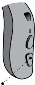
Para activar y desactivar el modo vuelo mantenga presionado el Pulsador inferior durante 7 segundos.
