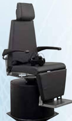
Interacoustics Orion Drehstuhl – zur Durchführung von rotatorischen Untersuchungen.
