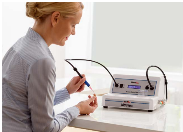
Vakuumsonde und Druckluftsonde arbeiten gleichzeitig.
