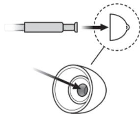
Insérez le tube fin exactement au milieu de l'embout afin de bien le mettre en place.
