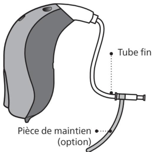
Le tube fin utilise l'un des embouts suivants :
