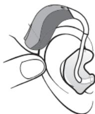
Tirez légèrement sur le lobe de l'oreille et appuyez sur l'embout dans la direction du conduit auditif.
