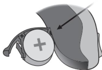
Insérez la nouvelle pile dans le tiroir pile. Insérez-la depuis le dessus, PAS depuis le côté.
