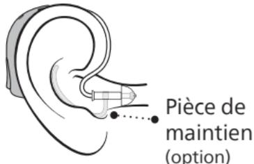
Insérez doucement l'embout dans votre conduit auditif jusqu'à ce que le tube fin se loge dans votre oreille.
