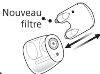
Insérez le bras de retrait vide dans le pare cérumen de l'embout et retirez-le.
