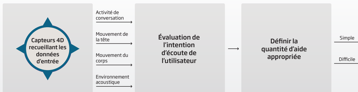
Figure 3. Le processus de la technologie de capteurs 4D : les capteurs 4D recueillent des données d'entrée dans les quatre dimensions, l'entrée est évaluée pour interpréter l'intention de l'utilisateur et combinée en un seul ensemble de paramètres qui définissent la quantité d'aide appropriée pour que les fonctionnalités restantes de MSI 3.0 puissent agir.
