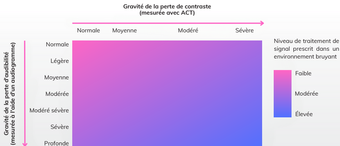
Figure 10 : Lors de l'utilisation d'un pré-réglage basé sur ACT, le niveau de traitement de signal dans le bruit fourni à un utilisateur individuel dépendra à la fois de sa perte d'audibilité et de la sévérité de sa perte de contraste.
