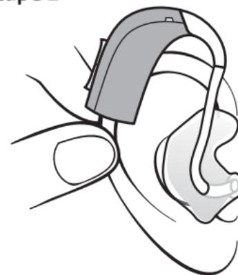
Tirez légèrement sur le lobe de l'oreille et appuyez sur l'embout dans la direction du conduit auditif.
