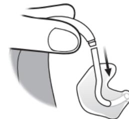
Déconnectez le tube et l'embout du coude. Tenez le coude fermement lorsque vous détachez le tube. Sinon, l'appareil pourrait être endommagé.
