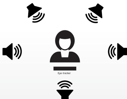
Figure 1 : Configuration spatiale des enceintes : quatre haut-parleurs ont été placés sur les côtés et à l'arrière des participants, c'est-à-dire à +/-90° et +/-150° mettant en concurrence les 4 interlocuteurs (un interlocuteur par haut-parleur) et le bruit de fond. Le haut-parleur cible est positionné à l'avant à 0°. La distance entre la caméra et les participants était d'environ 60 cm. L'expérimentation a été réalisée dans une cabine insonorisée.
