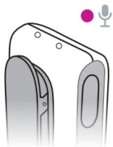
Appuyez sur le bouton et maintenez-le enfoncé pendant 10 secondes jusqu'à ce que le voyant d'état passe au MAGENTA. EduMic est maintenant en mode bobine d'induction et le microphone EduMic est désactivé. La portée de fonctionnement est de 3 m.
