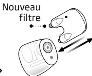
Insérez le bras de retrait vide dans le pare cérumen de l'embout. Retirez le pare cérumen.
