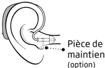
Insérez doucement l'embout dans votre conduit auditif jusqu'à ce que le tube fin se loge dans votre oreille. Si le tube fin possède une pièce de maintien, placez-la dans l'oreille de façon à ce qu'elle suive le contour de l'oreille.
