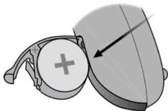
Insérez la nouvelle pile dans le tiroir pile. Insérez-la depuis le dessus, PAS depuis le côté.
