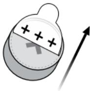
Retirez l'étiquette autocollante sur le côté positif (+) de la nouvelle pile.
