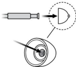
Insérez le tube fin exactement au milieu de l'embout afin d'obtenir une fixation solide.
