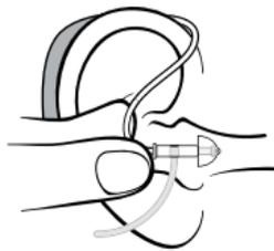
Tenez la courbe du tube entre votre pouce et votre index. L'embout doit être orienté vers l'ouverture du conduit auditif.
