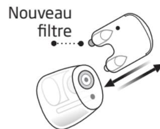
Insérez le bras de retrait vide dans le pare-cérumen à l'intérieur du Micro-Embout et retirez-le.
