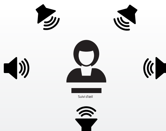
Figure 2. Configuration spatiale des haut-parleurs. Le haut-parleur cible qui présente la phrase est placée à 0°. Le 4-talker-babble est présenté par les haut-parleurs à +/- 90° et à +/- 150° (ce qui correspond à un orateur par haut-parleur). La distance entre le participant et la caméra était d'environ 60 cm.
