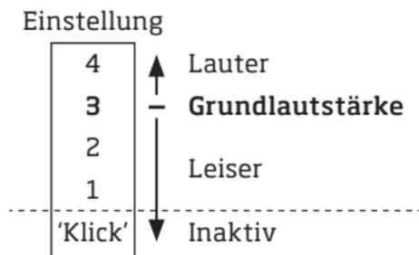
Die vom Hörgeräteakustiker eingestellte „Grundlautstärke“ entspricht der Stufe 3 des Lautstärkellers. Diese kann optional über zwei Signaltöne angezeigt werden.
