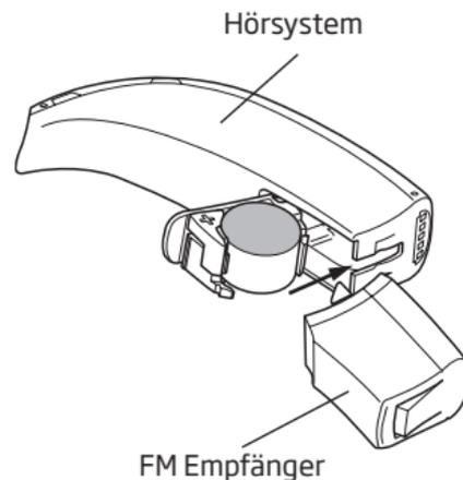
Ihr Hörgeräteakustiker kann für Sie beide Zusatzprogramme aktivieren. Wenn beide Zusatzprogramme aktiviert worden sind, startet das Hörsystem bei aufgesetztem FM-Schuh automatisch mit der Kombination von FM-Signal und Hörgerätemikrofon-Signal. Durch Drücken des Programmtasters gelangen Sie dann in das reine FM-Signal-Programm.
