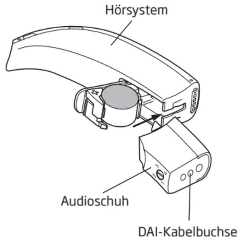
Ihr Hörgeräteakustiker kann für Sie beide Zusatzprogramme aktivieren. Wenn beide Zusatzprogramme aktiviert worden sind, startet das Hörsystem bei aufgesetztem Audioschuh automatisch mit der Kombination von Audiosignal und Hörgerätemikrofon-Signal. Durch Drücken des Programmtasters gelangen Sie dann in das reine Audiosignal-Programm.
