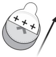
Ziehen Sie die Schutzfolie von der „+“-Seite der neuen Batterie ab. Warten Sie 1-2 Minuten, damit die Batterie Luft ziehen kann.
