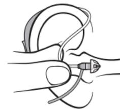
Halten Sie den Lautsprecher zwischen Daumen und Zeigefinger an seiner Biegung. Das Ohrstück sollte gerade zum Gehörgang zeigen.
