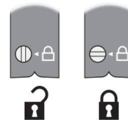
Achten Sie darauf, dass das Batteriefach vollständig geschlossen und eingerastet ist. Drehen Sie die Schraube in die gesicherte Position (waagrecht).
