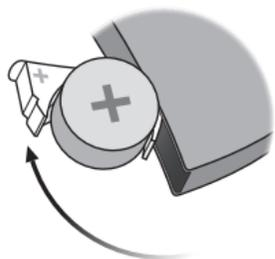
Öffnen Sie das Batteriefach vollständig. Nehmen Sie die Batterie heraus.
