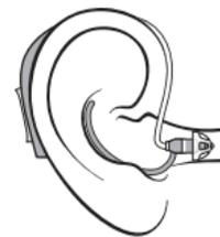
Schieben Sie das Ohrstück vorsichtig in den Gehörgang, bis das Kabel des Lautsprechers eng am Kopf anliegt.
