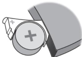
Setzen Sie die neue Batterie in das Batteriefach ein. Achten Sie darauf, dass die „+“-Zeichen auf Batterie und Batteriefach in eine Richtung zeigen.
