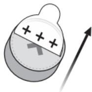
Ziehen Sie die Schutzfolie von der „+“-Seite der neuen Batterie ab. Warten Sie 1-2 Minuten, damit die Batterie Luft ziehen kann.
