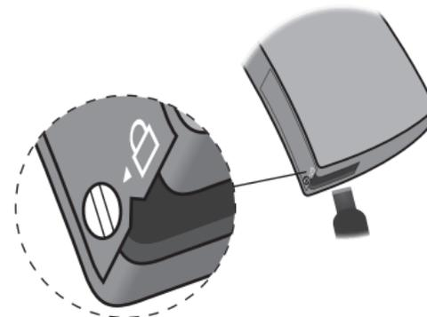
Drehen Sie die Schraube mit einem Schraubendreher in die entsicherte Position (senkrecht).
