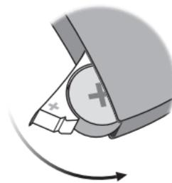
Schließen Sie das Batteriefach. Es ertönt eine Startmelodie. Halten Sie das Ohrstück dicht ans Ohr, damit Sie die Startmelodie hören.
