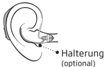
Schieben Sie das Ohrstück vorsichtig in den Gehörgang, bis das Kabel der Hörerattrappe eng am Kopf anliegt. Wenn die Hörerattrappe Ihres CROS-Senders über eine Halterung verfügt, setzen Sie diese so ins Ohr, dass sie sich an der Kontur des Ohrs anpasst.
