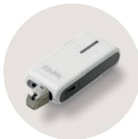
EduMic verbindet beliebig viele kompatible Oticon-Hörsysteme über einen Standard-Europin-Anschluss mit einem vorhandenen externen Mikrofonsystem im Klassenzimmer.
