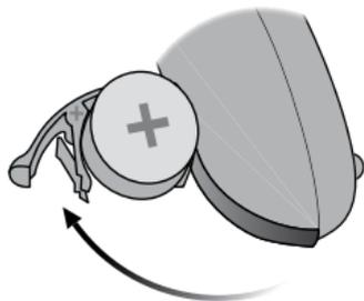
Öffnen Sie das Batteriefach vollständig. Nehmen Sie die Batterie heraus.
