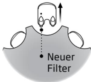
Entnehmen Sie das Werkzeug aus dem Spender. Das Werkzeug hat zwei Stifte: einen leeren zum Herausnehmen des alten Cerumenschutzes und einen mit dem neuen Cerumenschutz.
