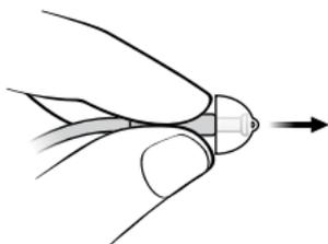
Halten Sie das Ende des Dünnschlauchs fest, während Sie das Ohrstück abziehen.
