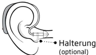
Schieben Sie das Ohrstück vorsichtig in den Gehörgang, bis der Dünnschlauch eng am Kopf anliegt. Wenn der Dünnschlauch über eine Halterung verfügt, setzen Sie diese so ins Ohr, dass sie sich an die Kontur des Ohrs anpasst.
