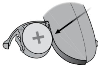
Setzen Sie die neue Batterie in das Batteriefach ein. Legen Sie die Batterie **VON OBEN** ein, **NICHT** von der Seite.
