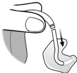
Ziehen Sie den Schlauch und das Ohrstück vom Hörwinkel ab. Halten Sie den Hörwinkel dabei gut fest. Ansonsten kann das Hörsystem beschädigt werden.
