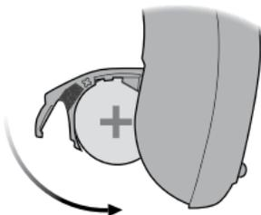
Schließen Sie das Batteriefach und stellen Sie sicher, dass es vollständig geschlossen ist.
