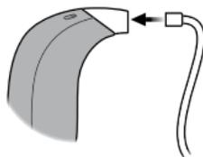
Verbinden Sie anschließend den Dünnschlauch wieder mit dem Hörsystem.
