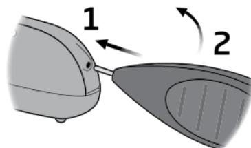
Stecken Sie die Spitze des Werkzeugs in die Öffnung an der Rückseite des Batteriefachs.
