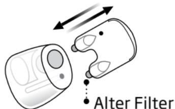
Setzen Sie den neuen Cerumenschutz mit dem anderen Stift ein. Entfernen Sie das Werkzeug und entsorgen Sie es.
