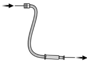
Führen Sie das Reinigungswerkzeug durch den gesamten Dünnschlauch.
