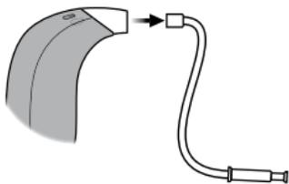
Ziehen Sie den Dünnschlauch aus dem Hörsystem und entfernen Sie das Ohrstück.
