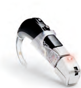
Hörgerät mit FM-Schuh und universellem FM-Empfänger
