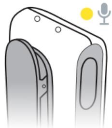
Quando il ricevitore FM è collegato, l'indicatore di stato è GIALLO.
