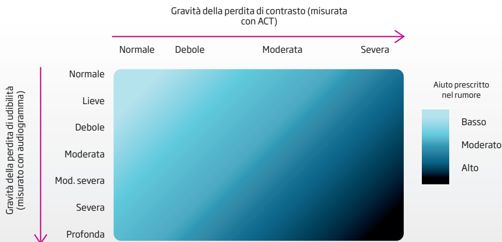
Figura 10: Quando si utilizza una prescrizione basata su ACT, il livello di aiuto nel rumore fornito a un singolo utente dipenderà sia dalla perdita di udibilità che dalla gravità della perdita di contrasto.
