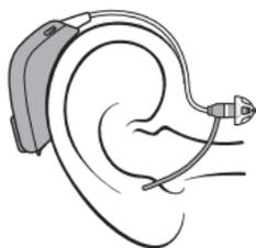
Posizioni l'apparecchio acustico dietro l'orecchio. Il ricevitore deve essere sempre utilizzato con l'auricolare. Utilizzi esclusivamente componenti progettati per il suo apparecchio acustico.
