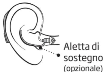
Spinga con delicatezza l'auricolare all'interno del condotto uditivo finché il filo dell'altoparlante non è posizionato vicino alla testa. Se l'altoparlante è dotato di un'aletta di sostegno, la posizioni all'interno dell'orecchio in modo da seguirne il profilo.
