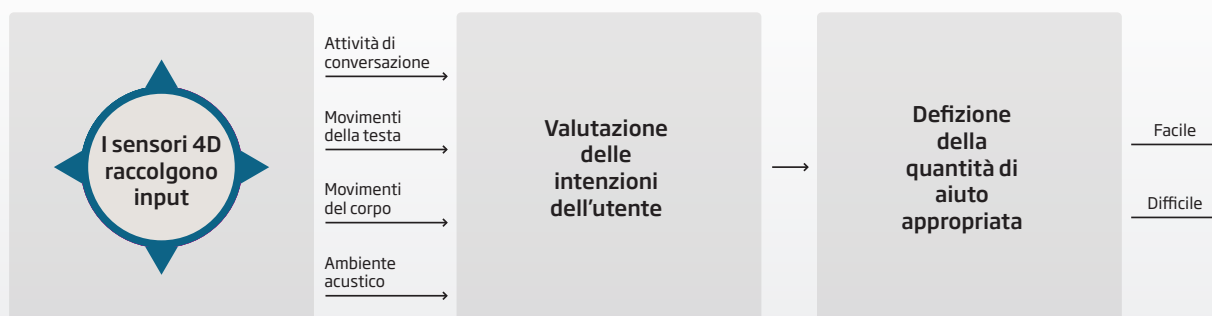
Figura 3. Il processo della tecnologia dei sensori 4D: i sensori 4D raccolgono input nelle quattro dimensioni, l'input viene valutato per interpretare l'intenzione dell'utente e combinato in un unico insieme di parametri che definiscono la quantità appropriata di aiuto per le restanti funzionalità in MSI 3.0 su cui agire.
