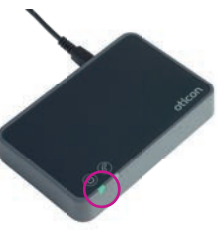
Controleer of Phone 2.0 aan staat (het indicatielampje moet continu groen branden).
