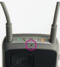
Draag Streamer Pro met de neklus en controleer of de microfoon niet afgedekt wordt door kleding. Zorg dat u goed in de microfoon van Streamer Pro kunt praten.
