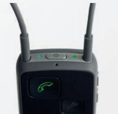
Druk de telefoontoets op Streamer in om het gesprek aan te nemen. U hoort een bevestigingspiep en vervolgens de stem van de persoon die belt.
