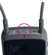
Zet Streamer Pro in de koppelingsstand door de aan/uit toets 5 seconden ingedrukt te houden totdat het blauwe lampje gaat knipperen.
