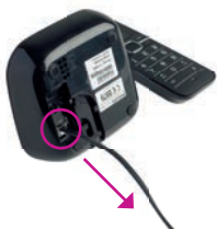
Maak de telefoonlijn los van de telefoon of het basisstation van de draagbare telefoon.
