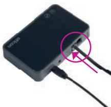
Bevestig de telefoonlijn in het 'IN' contact van Phone 2.0.
