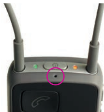
Draag Streamer Pro met de neklus en controleer of de microfoon niet afgedekt wordt door kleding. Zorg dat u goed in de microfoon van Streamer Pro kunt praten.
