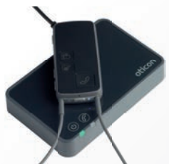
Plaats Streamer Pro op Phone 2.0 - de koppeling duurt 20-60 seconden. Als de stroomindicatie op Phone 2.0 en de aan/uit indicatie op Streamer Pro continu blauw blijven branden, is de koppeling voltooid.
