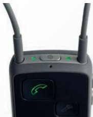
Tijdens het gesprek zijn de statusindicatie en de aan/uit indicatie aan de bovenkant van Streamer Pro continu groen.
