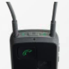
Aby odebrać połączenie, naciśnij przycisk telefonu na Streamerze. Usłyszysz sygnał potwierdzający, a następnie głos rozmówcy.
