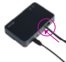
Podłącz kabel do gniazda „IN” adaptera telefonicznego.
