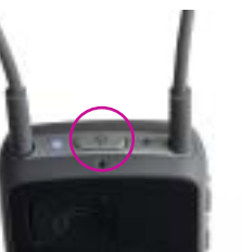
Wprowadź Streamer w tryb parowania, naciskając i przytrzymując przez 5-6 sekund przycisk wł./wył. w górnej części Streamera, aż wskaźnik zacznie migać na niebiesko.
