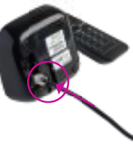
Podłącz drugi koniec kabla telefonicznego do telefonu (lub stacji bazowej).
