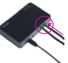
Podłącz kabel telefoniczny (w zestawie) do gniazda „OUT” adaptera.
