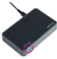
Upewnij się, że adapter telefoniczny jest włączony (wskaźnik zasilania świeci stale na zielono).
